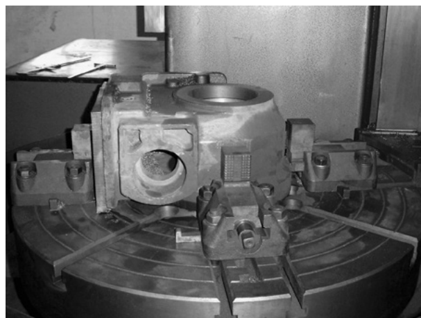
Финишная обработка корпусной детали
